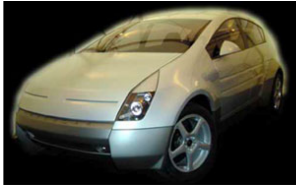
图 1：2000 年设计的 Revolution (革命) 概念车，一种超轻 (857 公斤) 碳纤维中型多用途运动车。
